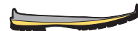
C - Avec inter-semelle moulé ou EVA Bloc semelle regroupant partie amortissante et partie gomme semelle. Selon modèle en PU ou en EVA.
